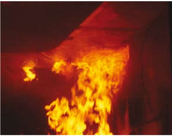
Fig. 15 - Ataque térmico a 300 kW (incendio generalizado)
