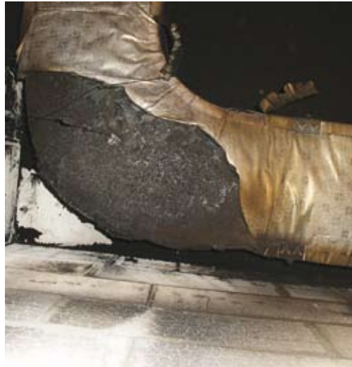
Fig. 16 - El conducto P3ductal muestra las consecuencias del incendio solamente en la parte afectada directamente por las llamas
