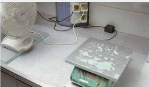
**secuencia 3** después de la acción de “ensuciado”, la muestra estándar se somete a un flujo de aire generado un ventilador que se pone en funcionamiento por 2 minutos a velocidad 1 y por dos minutos a velocidad 2. Al final de la prueba, se ven en la muestra amplias zonas donde ha quedado depositada la suciedad.
