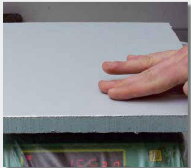
**secuencia 2** el panel P3ductal careplus muestra su efecto de autolimpieza. Después de la rotación las partículas han sido eliminadas casi completamente.
