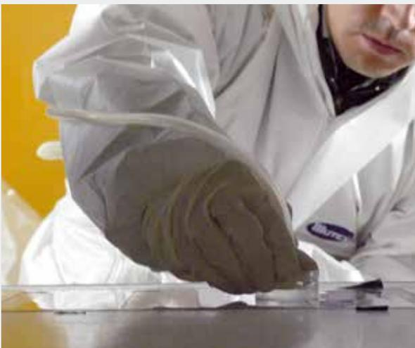
*secuencia 2 extracción de una muestra de partículas depositadas en el interior del conducto según lo establecido por el NADCA Vacuum Test*
