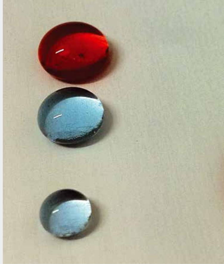
gotas se deslizan naturalmente arrastrando consigo las impurezas que se pudieran haber depositado. El ángulo de contacto es el ángulo entre la dirección de la tensión sólido-líquido y la dirección de la tensión líquido-vapor, tangente a la superficie externa de la gota, con el vértice en el punto trifásico líquido-sólido-vapor.
