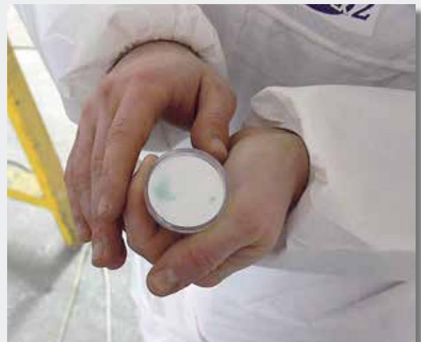
*secuencia 3 detalle de la suciedad residual extraída del interior del conducto de muestra en chapa zincada*
