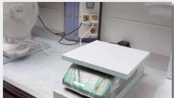
**secuencia 4** después de la acción de “ensuciado”, la muestra P3ductal careplus se somete a un flujo de aire generado por un ventilador que se pone en funcionamiento por 2 minutos a velocidad 1 y por dos minutos a velocidad 2. Al final de la prueba, la muestra queda prácticamente limpia.
