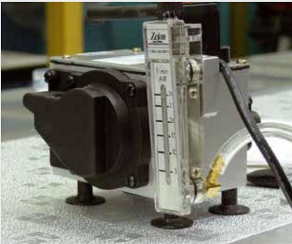
*el sistema de extracción de las muestras homologado según lo que establece el NADCA Vacuum Test*
